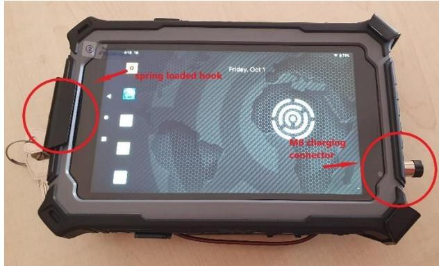
9.9.2. Ne placez jamais l'appareil dans le support dans une autre orientation que celle indiquée ci-dessus. Cela empêchera la charge via le support et endommagera les boutons matériels.
